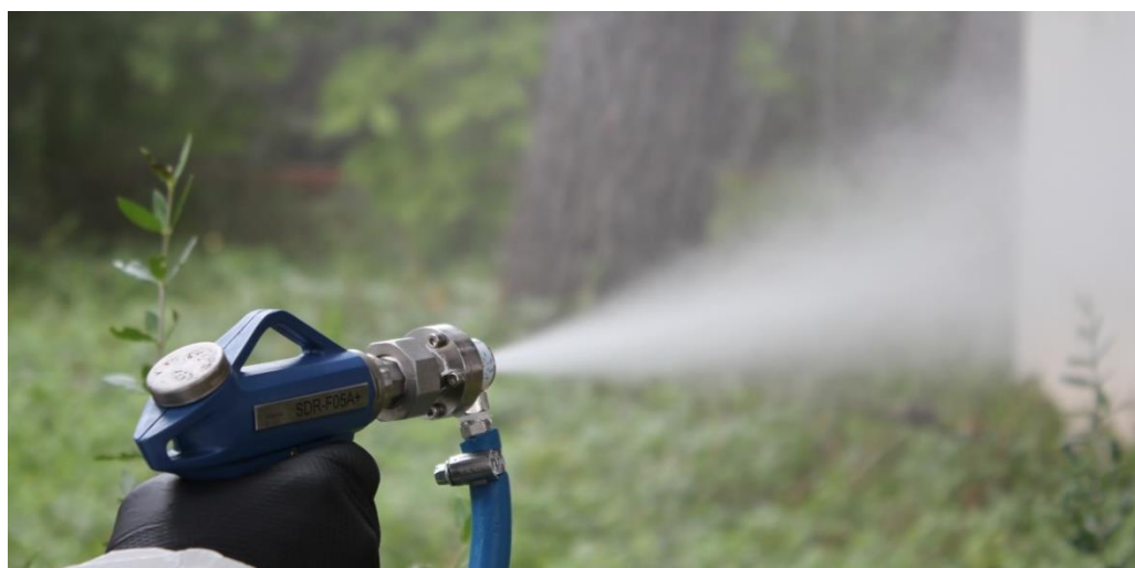
Figura 1. Detalle del cono de niebla dinámico COUNTERFOG®
