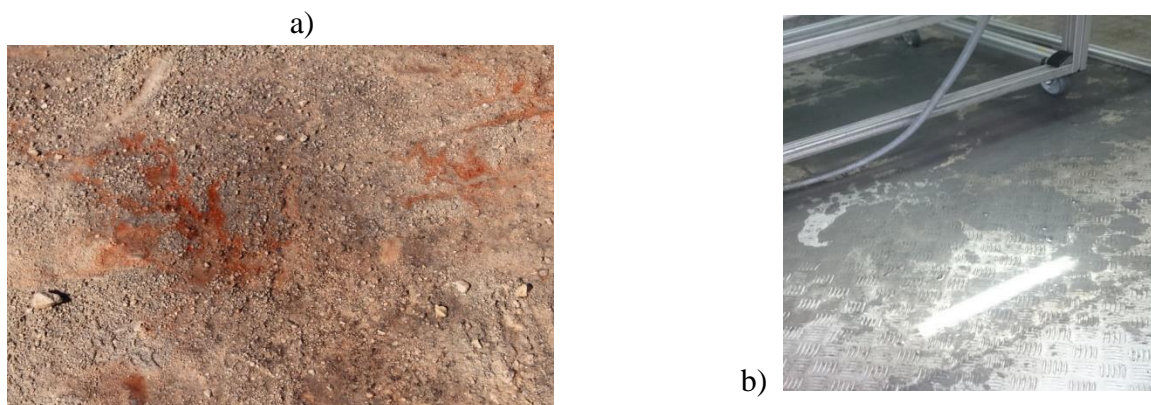
Figura 4. Residuos depositados sobre el suelo o superficies después de depurar el aire con Counterfog.
