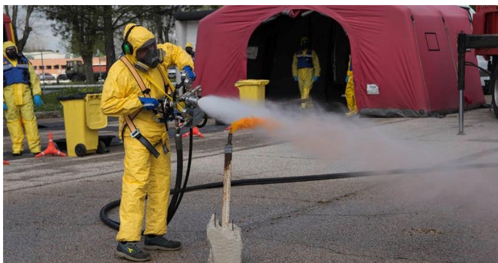
Figura 3. Captura y deposición de humo de color generado en una bengala mediante una boquilla portátil de Counterfog. Ensayo realizado en cooperación con la UME en la base aérea de Torrejón. La absorción. Captura y colapso del humo de colores hace visible al ojo humano el proceso.
