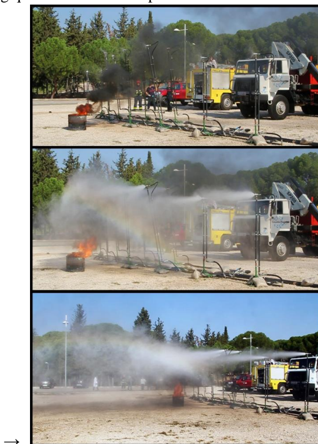
Figura 11. Ensayo en campo abierto de una barrera de 5 boquillas Counterfog (portátil) impidiendo el paso de humo.
