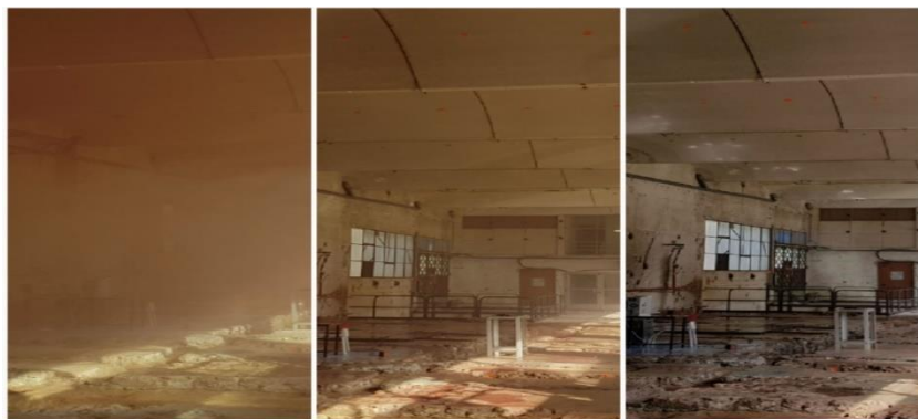
Figura 6. Actuación de un conjunto de boquillas Counterfog (fijo) para la limpieza de humo en una nave. Izquierda: nave repleta de humo. Centro: después de 6 minutos de aplicación de Counterfog. Derecha: después de 9 minutos de aplicación de Counterfog.
